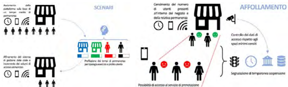
Figura 9.30. Schema di funzionamento dell'algoritmo di formulazione di scenari sull'utilizzo degli spazi e sul monitoraggio dell'affollamento.
