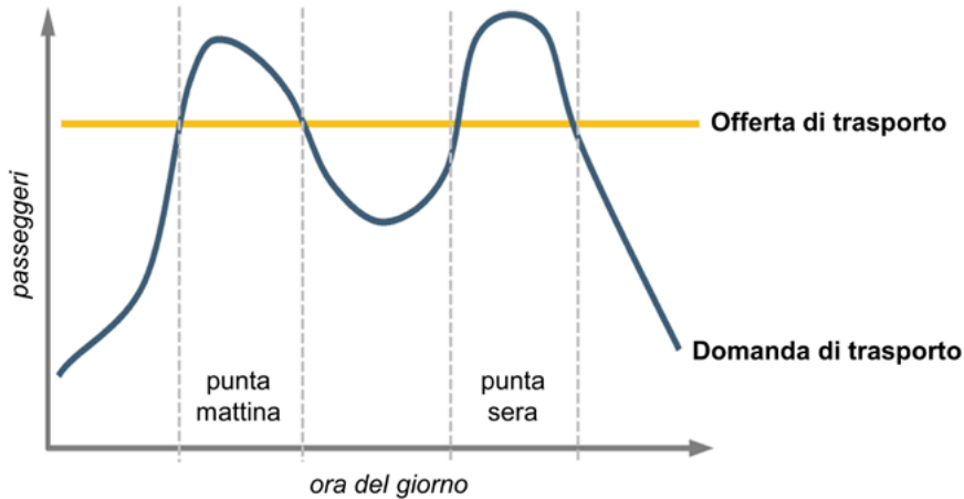
Figura 8.3. Andamento di domanda e offerta di trasporto nel corso di una giornata ferialo tipo. Adattato da (Rodrigue & Notteboom, 2020).
