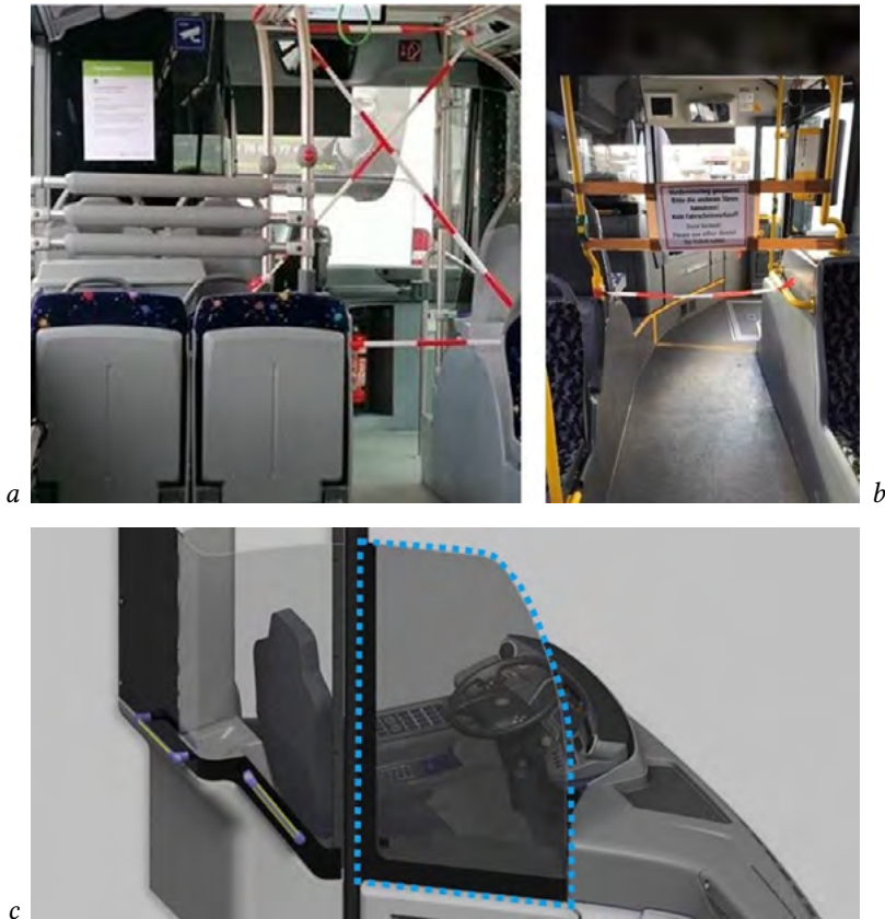
Figura 8.10. (a) Sistema con divieto di accesso dalla porta anteriore (b) Sistema di isolamento della cabina dell'autista.
