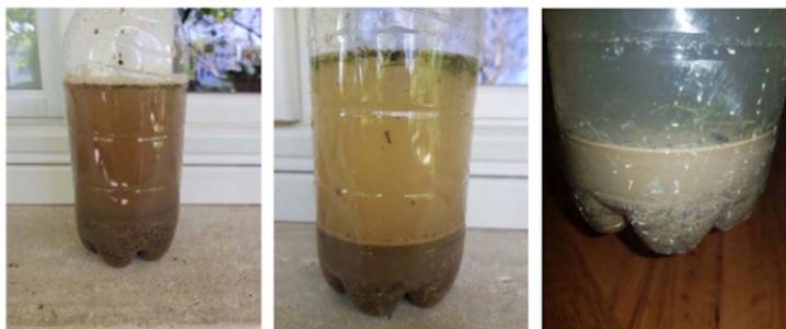
Figura 10 – Immagini della progressiva sedimentazione della sospensione di suolo e acqua. Da sinistra: sospensione di suolo e acqua appena agitato, sedimentazione dopo 30 min, sedimentazione dopo 24 h.
