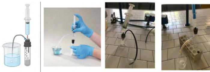
Il bicchiere contiene una soluzione di acqua o di acqua oceanica; il gassificatore è assemblato in modo tale che il reagente solido sia contenuto nel tubo, mentre quello liquido viene iniettato attraverso la siringa in una delle due aperture; la seconda apertura è quella che fa fuoriuscire il gas. Gli apparati sono descritti nella sezione “Indicazioni per l’insegnante”
