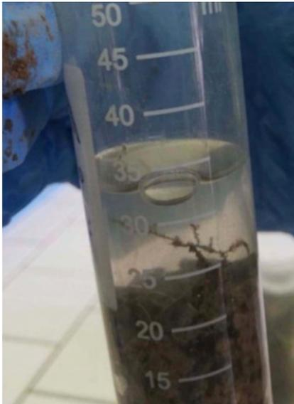
Figura 7 – Cilindro che contiene una sospensione di suolo e acqua.
