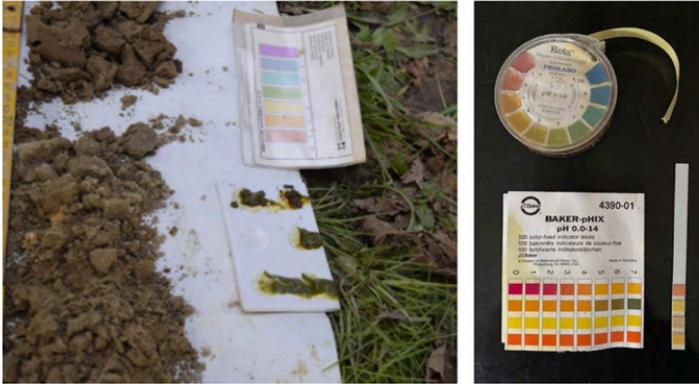
Figura 16 – Misura del pH del suolo con indicatore o con cartine tornasole.
